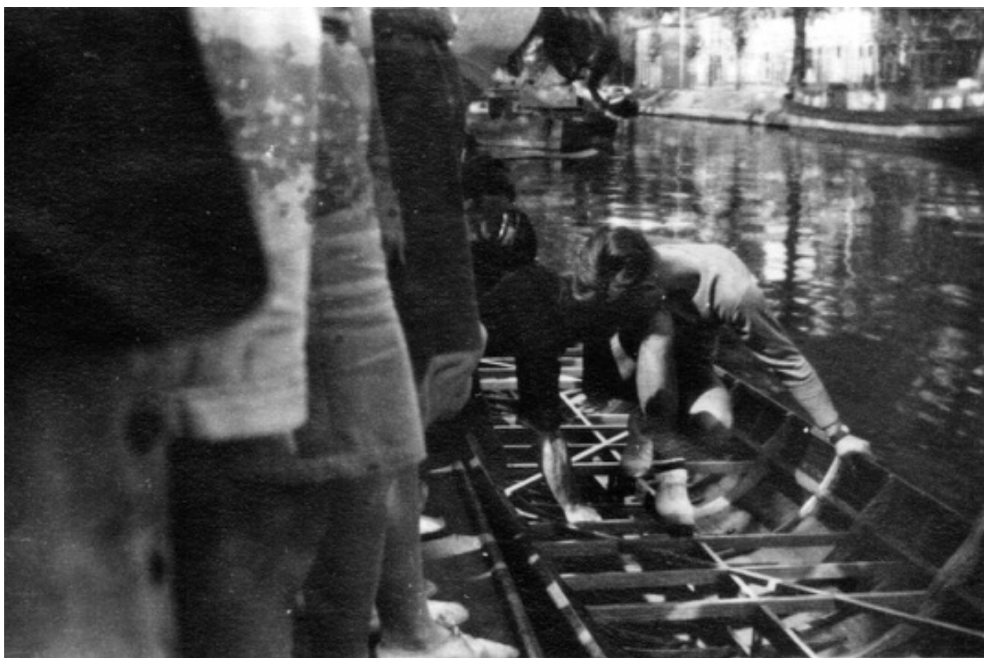
De Loki wordt getest op waterdichtheid voordat slidings, voetenborden en riggers aangebracht worden. 1948
